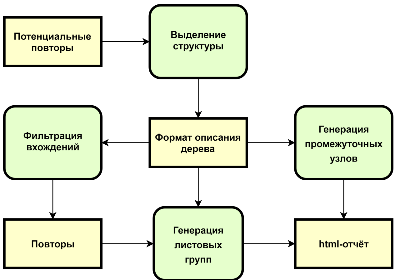
Рис. 4: Схема построения дерева повторов
